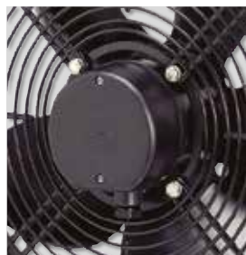
Boîte à bornes Boîte à bornes (ignifugée V0) à l'arrière du moteur avec presse étoupe PG-11.
