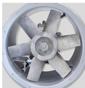
Hélice équilibrée dynamiquement Hélice d'une seule pièce à pales fixes en aluminium. Equilibrage selon la norme ISO 1940, pour un fonctionnement sans vibrations.
