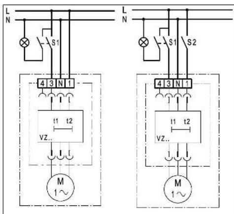
Le régime intermittent commande automatiquement l'activation du ventilateur selon la durée d'intervalle programmée lorsque le ventilateur n'a pas été activé auparavant. Les intervalles sont réglables de 1 à 15 heures. La durée d'enclenchement s'élève à 10 minutes.
