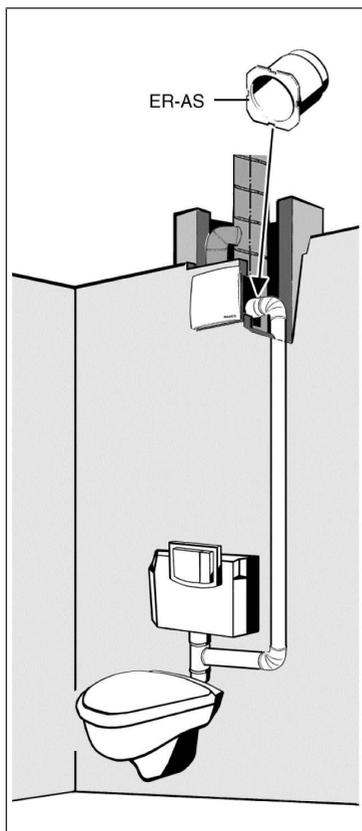
Les unités de boîtiers ER-UP/G et ER-UPD peuvent être reliées au conduit de rinçage des WC par le raccord d'aspiration ER-AS. Une section de conduit de DN 70 permet de faibles vitesses de déplacement de l'air dans le conduit de liaison et une aspiration efficace et sans courant d'air des odeurs.
