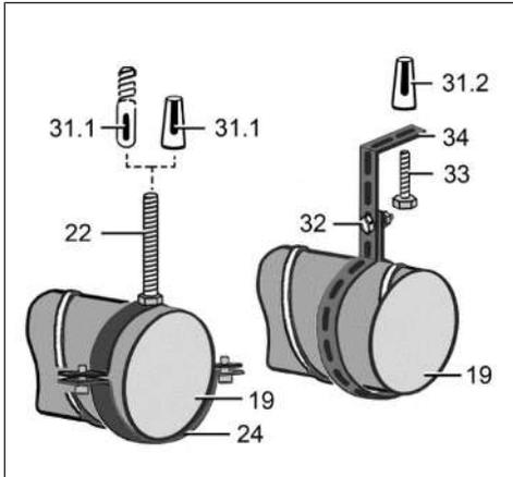
**i** **Maintenir un écart maximal de 1,5 m entre les fixations de gaines rondes .**
