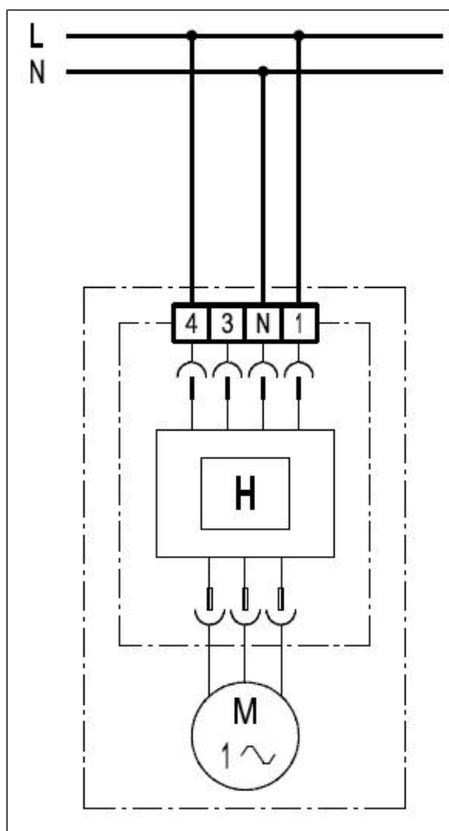
Le ventilateur fonctionne en charge de base, la commande en fonction de l'humidité est active. Dès que le point d'activation est dépassé, le ventilateur passe automatiquement au mode Charge pleine. Dès que le point de désactivation n'est pas atteint, le ventilateur revient automatiquement au mode Charge de base.
