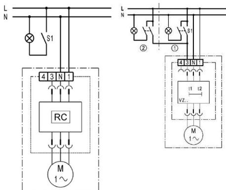
Le ventilateur démarre après l'activation de l'éclairage de la pièce (avec interrupteur S1). Le ventilateur est désactivé dès que l'éclairage de la pièce est éteint.
