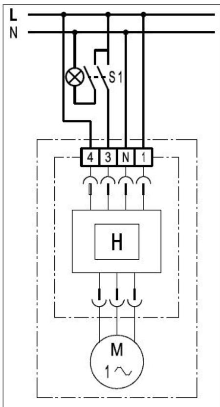
Le ventilateur fonctionne en charge de base. La commande en fonction de l'humidité est active, voir Réglage standard. L'interrupteur « S1 » permet de passer manuellement au mode Charge pleine. Lorsque le mode Charge pleine est désactivé avec « S1 », le ventilateur continue à fonctionner à charge pleine avec une durée de fonctionnement par temporisation de 6 minutes. Une fois ce temps écoulé, si l'humidité mesurée au ventilateur est :
