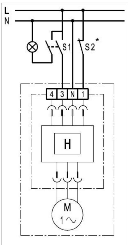
L'interrupteur « S1 » permet de mettre le ventilateur en marche manuellement à charge pleine. La commande en fonction de l'humidité est active. Après la désactivation avec « S1 », le ventilateur continue à fonctionner à charge pleine avec une durée de fonctionnement par temporisation de 6 minutes. Une fois ce temps écoulé, si l'humidité mesurée au ventilateur est
