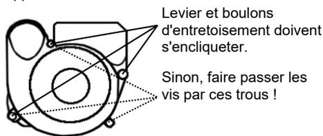
10. Pousser en parallèle l'insert de ventilateur / l'élément d'air sortant sur les deux boulons d'entretoisement. Veiller à l'encliquetage audible des deux ergots des boulons d'entretoisement et du levier à crans.
