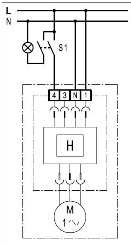
L'interrupteur « S1 » permet de mettre le ventilateur en marche manuellement en charge de base. La commande en fonction de l'humidité est active, voir Réglage standard. Si, en cas de désactivation manuelle avec l'interrupteur « S1 », le ventilateur se trouve en :
