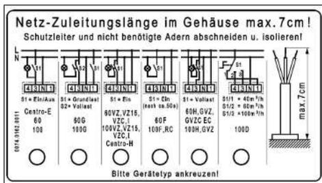
6. Cocher le type de ventilateur sur le schéma de branchement à l'intérieur du boîtier UP. Ceci permet d'éviter des erreurs au montage final si, par exemple, différents inserts de ventilateur doivent être montés dans le système.
