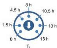
**Potentiomètre Ti** : durée de fonctionnement. Arrêt de la commande par intervalles sur butée gauche.
