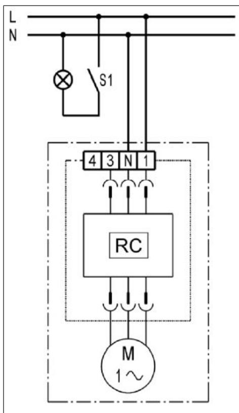
Le ventilateur est mis en marche et commuté progressivement par interrupteur radio.
