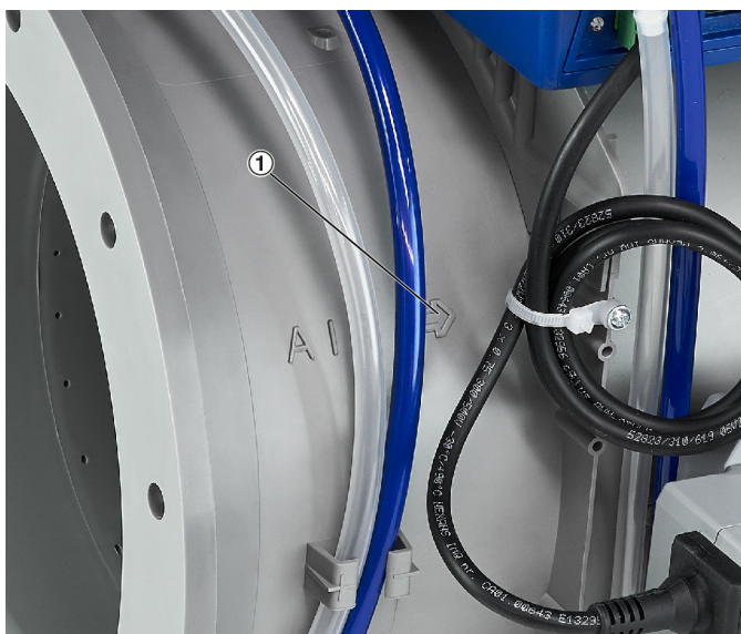
Fig. 9: Flèche de direction de l'air sur le TVLK
